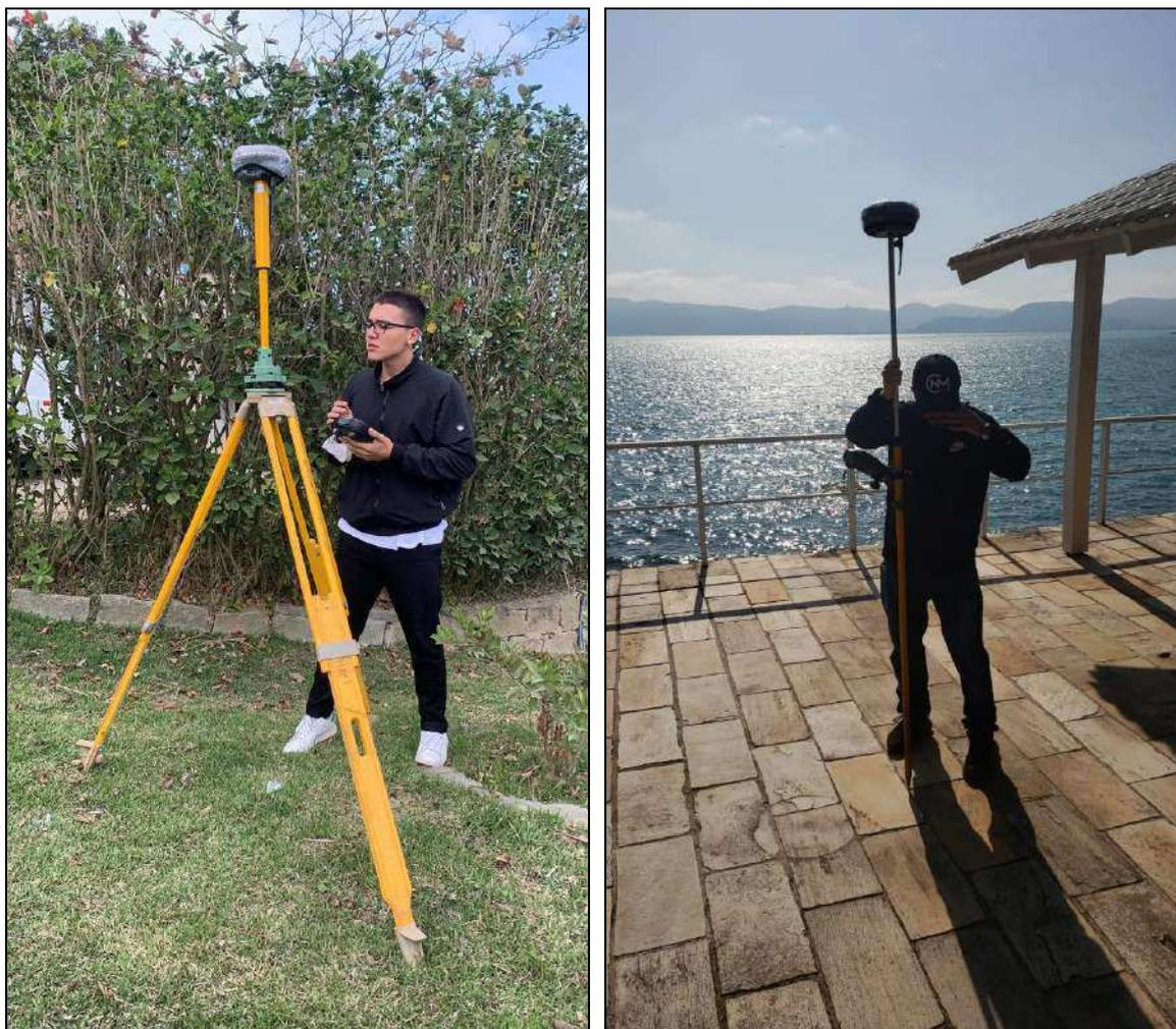
Figura 3. Detalhe da tecnologia do levantamento planialtimétrico realizado na propriedade do Sr. Odair Tramontin. Na imagem da esquerda pode ser observada a estação base e na imagem da direita a estação móvel (*rover*).
