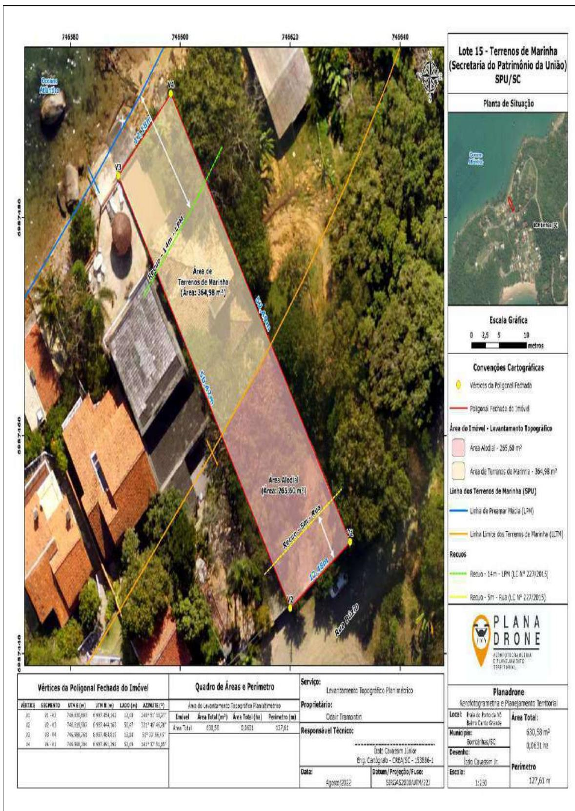
Figura 9. Área alodial e área de terreno de marinha do imóvel do Sr. Odair Tramontin a partir do levantamento topográfico planialtimétrico de julho de 2022.
