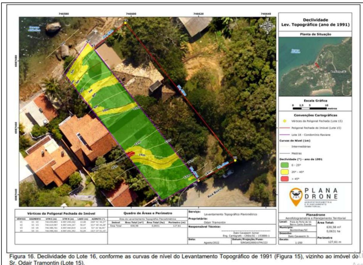
Figura 16. Declividade do Lote 16, conforme as curvas de nível do Levantamento Topográfico de 1991 (Figura 15), vizinho ao imóvel do Sr. Odair Tramontin (Lote 15).
